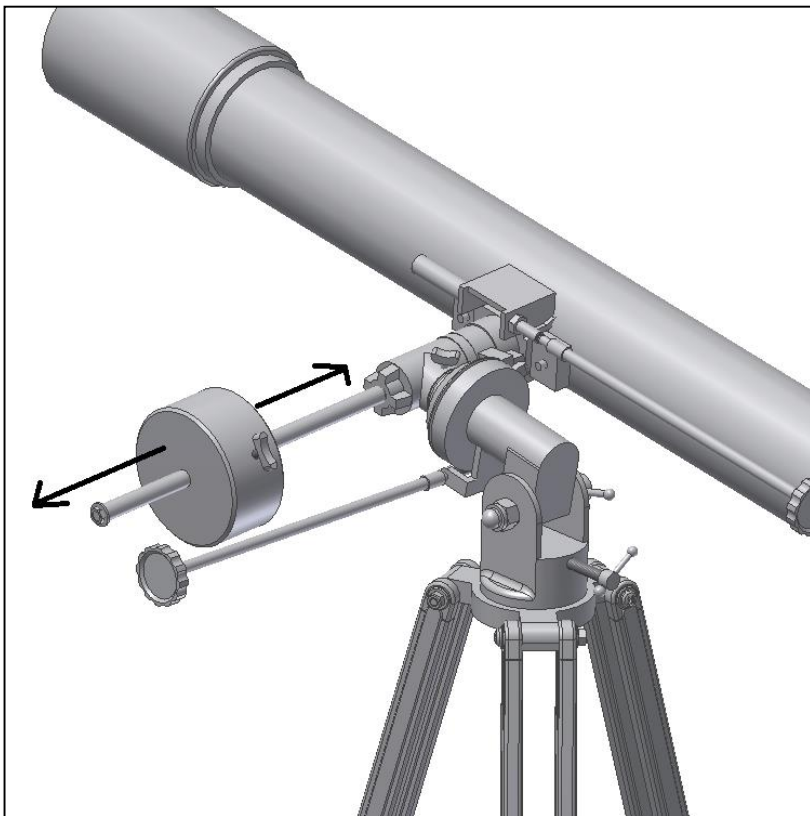
Abb. 10. Ausbalancieren der R.A-Achse mit dem Gegengewicht.
